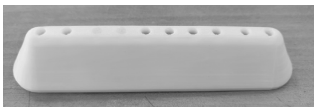
Рис. 5. Пример изготовления конструкции с помощью аддитивных технологий на основе 3D-модели:
