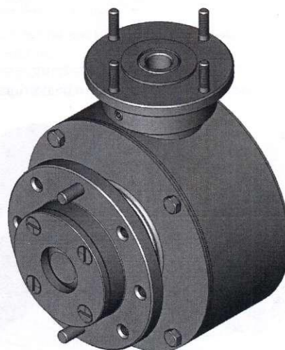
Рис. 4. Изометрия конического редуктора с характеристиками: Z_1 = 16 и Z_2 = 50 — число зубьев конических колес редуктора, m = 2,5 мм — модуль; M_{кр} = 250 Н·м — передаваемый крутящий момент, масса — 7,3 кг
