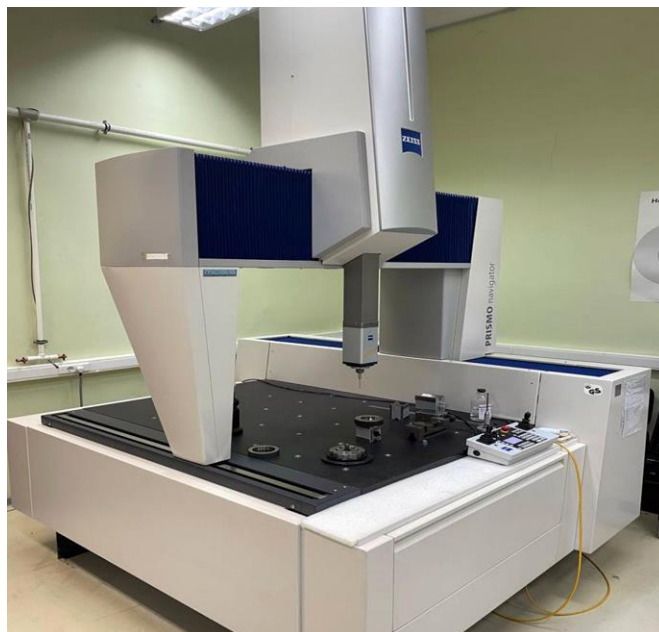
Рис. 2. Измерение круглости на Zeiss PRISMO navigator
