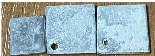
Рис. 5. Образцы после пропитки и сушки
