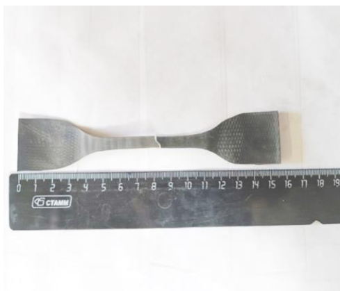
Рис. 3. Необлученный образец после испытаний
