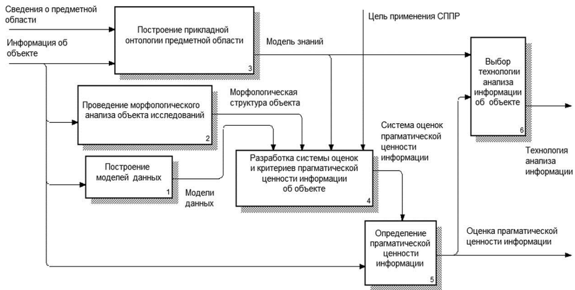
Функциональная декомпозиция задачи оценки моделирования информации о сложных технических объектах
