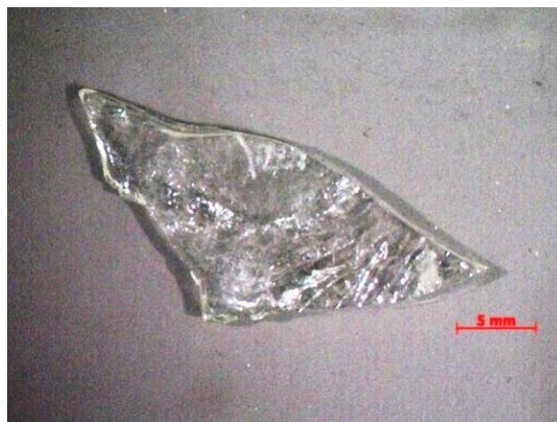
Рис. 1. Макросъемка образца, полученного свободным охлаждением с печью до затвердевания расплава, с последующим охлаждением на воздухе ( \times 3,75 )
