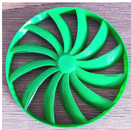
Рис. 3. Напечатанный на 3D-принтере двенадцатилопастной винт
