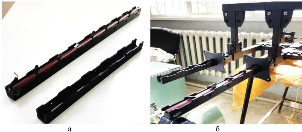
Рис. 3. Процесс сборки АКБ: а – аккумуляторные элементы в кассете; б – кассеты в несущей раме
