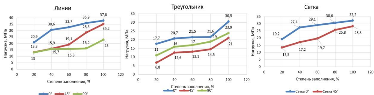
Рис. 1. Влияние схемы, степени заполнения и угла \alpha на прочность при растяжении
