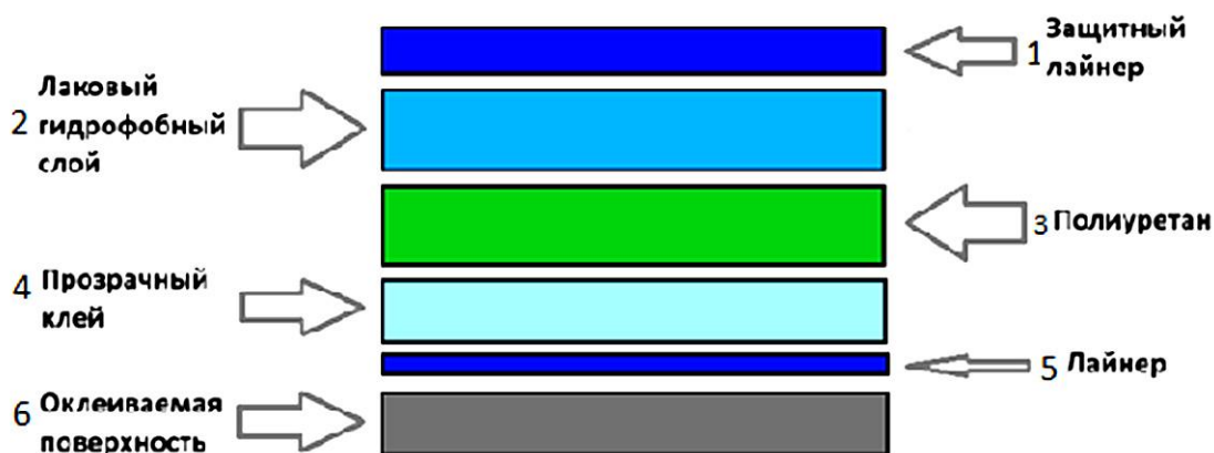
Рис. 1. Состав кузовного покрытия [2]
