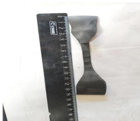
Рис. 4. Облученный образец после испытаний
