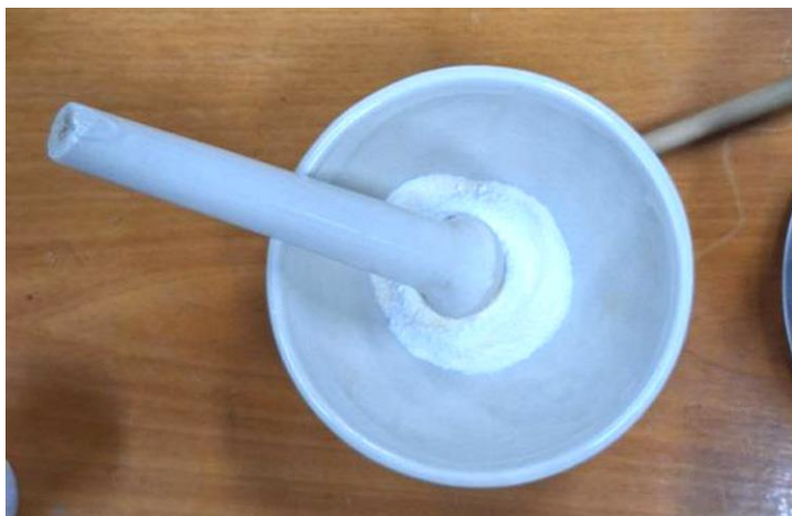
Рис. 1. Измельчение порошка ГА с использованием ступки
