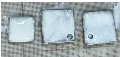
Рис. 4. Образцы после пропитки раствором MgO
