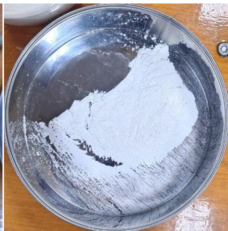
Рис. 2. Просеянный порошок ГА
