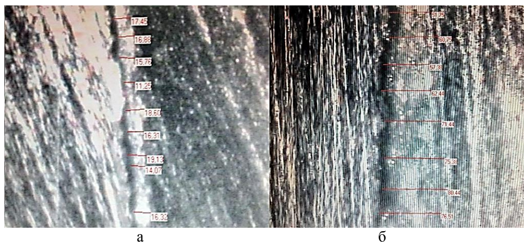
Рис. 1. Изображения торцов термически обработанных образцов стали 20X23N18 с измерениями толщины поверхностной оксидной пленки, сделанные с использованием анализатора изображений микроструктур АГПМ – 6М с компьютерной программой «Металлограф»: а – торец образца после отжига при температуре 950 °С с выдержкой 180 мин., б – торец образца после отжига при температуре 1200 °С с выдержкой 180 мин
