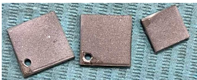
Рис. 3. Образцы после напыления порошка ГА
