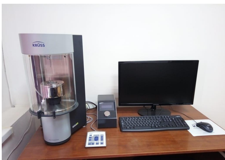
Рисунок 5 – Тензиометр K100 для измерения поверхностных свойств жидкостей
