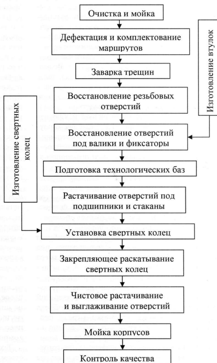
Рис. 1. Схема технологического процесса восстановления корпусных деталей
