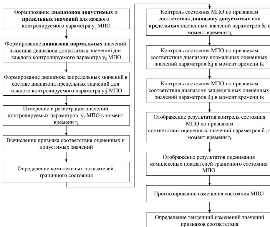
Рис. 3. Алгоритм способа комплексного контроля состояния многопараметрического объекта по разнородной измерительной информации
