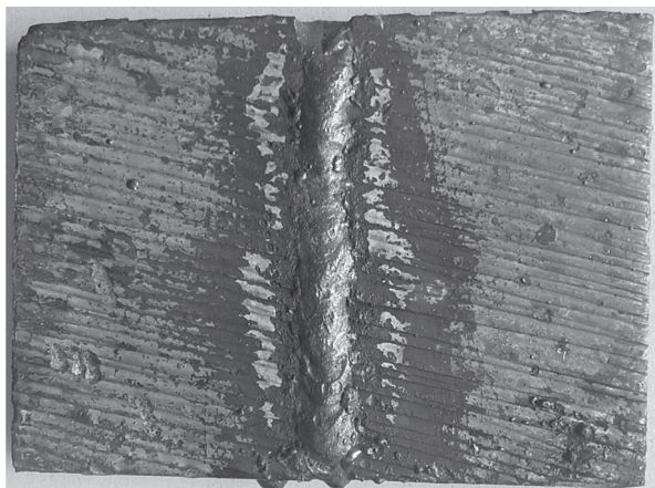
Рис. 2. Образец из соединения головки электродержателя ЭДП
