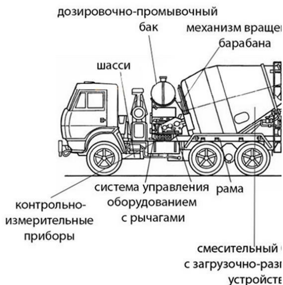
Рисунок 1 – Автобетоносмеситель 58146V (АБС-6К) на шасси КАМАЗ-65111
