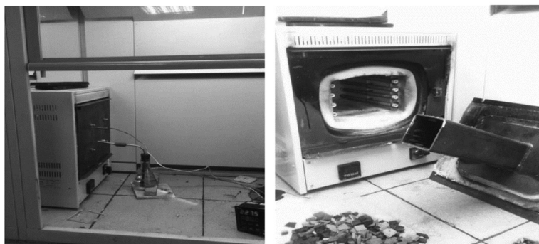
Рис. 1. Установка для получения торрефиката: а — схема установки; б — общий вид
