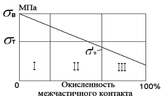
Рис. 3. Схема механизмов разрушения порошковых материалов:
