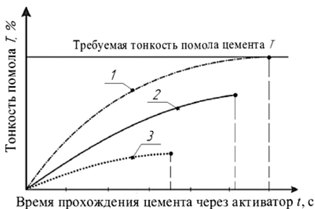
Рис. 2. Зависимость тонкости помола цемента от длительности цикла активации:
