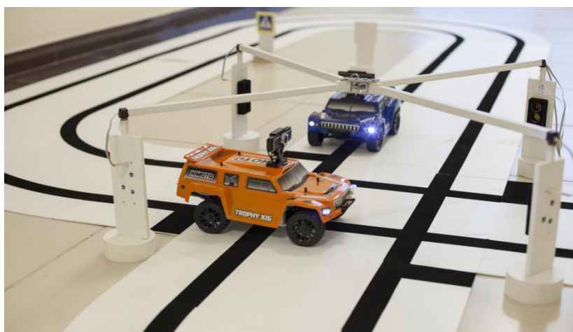
Рис. 1. Образец учебной платформы(стенда) с техническим зрением
