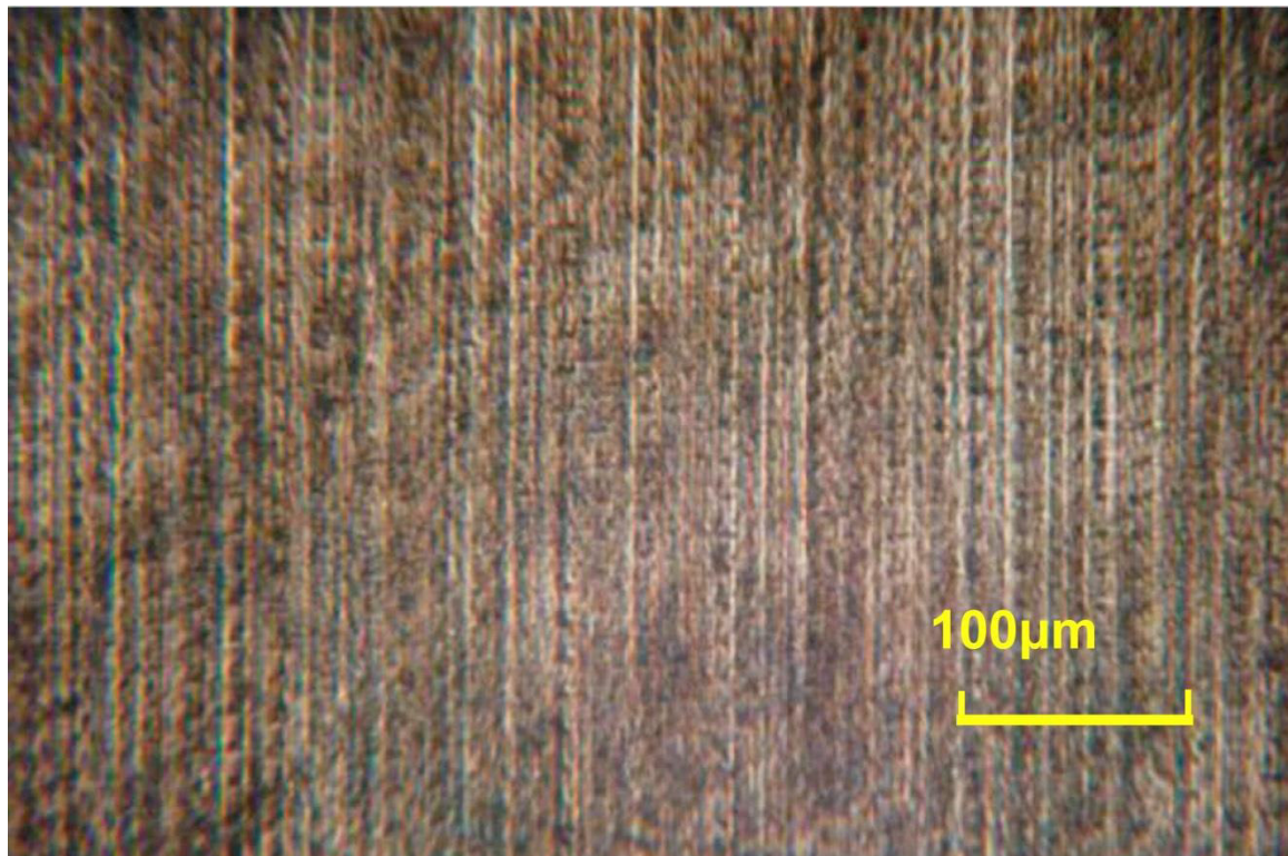
Рисунок 3 – Поверхность детали из алюминиевого сплава Д16Т после безабразивной ультразвуковой финишной обработки
