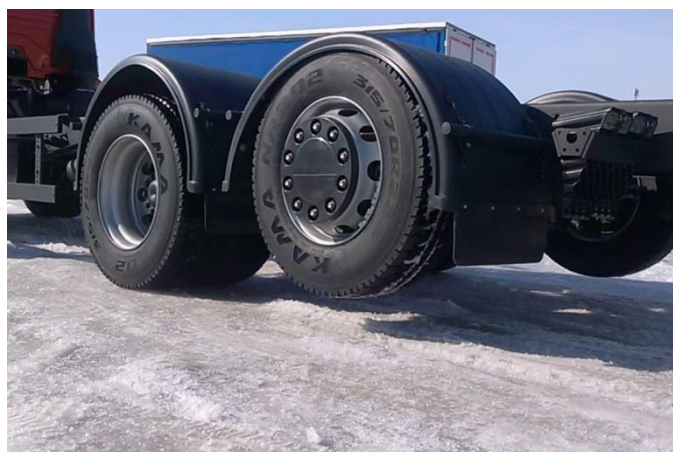
Рисунок 1 – «Ленивая» ось (мост) автомобиля-тягача в поднятом положении
