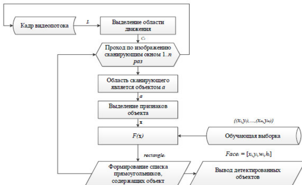
Рисунок 2 – Алгоритм обработки изображения методом опорных векторов
