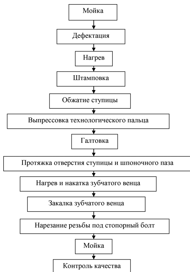
Рис. 4. Схема технологического процесса восстановления звездочек цепных передач (шаг 19,05 и 25,4 мм)
