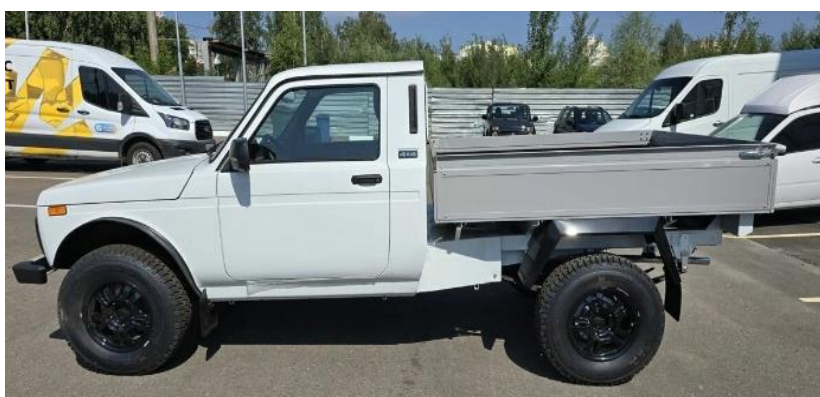
Рисунок 4 – Изолированное от кабины грузовое отделение
