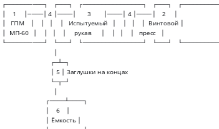
Рисунок 2 – Схема гидравлического испытательного стенда для проверки напорных пожарных рукавов
