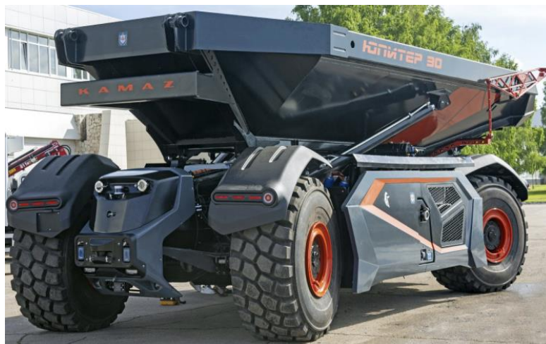
Рисунок 1 – Первый в России беспилотный самосвал - КАМАЗ-6559 «Юпитер 30»
