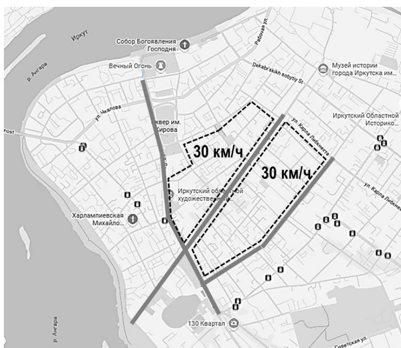
Рисунок 1 – Предлагаемые ограничения скорости движения в историческом центре Иркутска: улицы с ограничением скорости 50 км/ч и зоны успокоенного движения 30 км/ч
