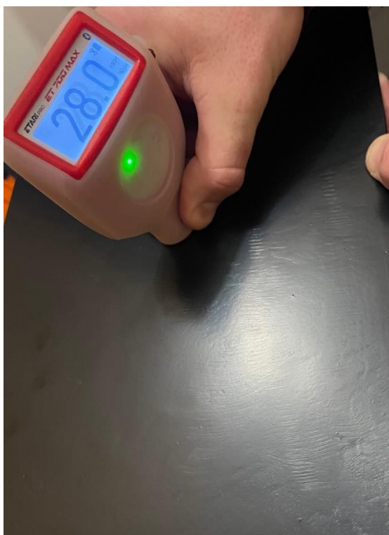
(измерение толщины краски, которая нанесена с помощью краскопульты)
