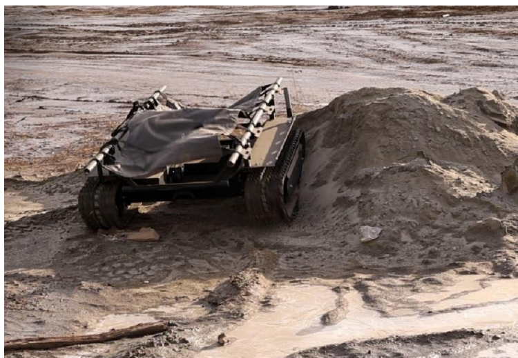
Рисунок 2 – Гусеничная беспилотная платформа для эвакуации раненых «Веном-тотем»
