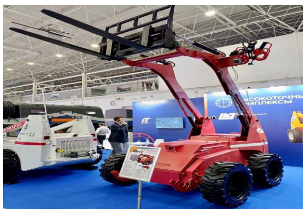
Рисунок 2 – Дистанционно-управляемый роботизированный комплекс Ант-1000ПМ с пожарным модулем (2024 г.)
