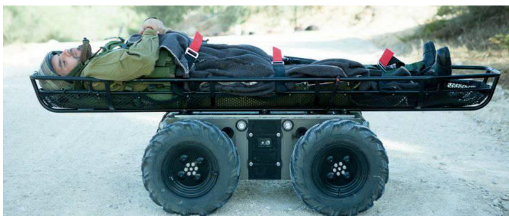
Рисунок 3 – Беспилотная колесная платформа грузоподъемностью до 250 кг
