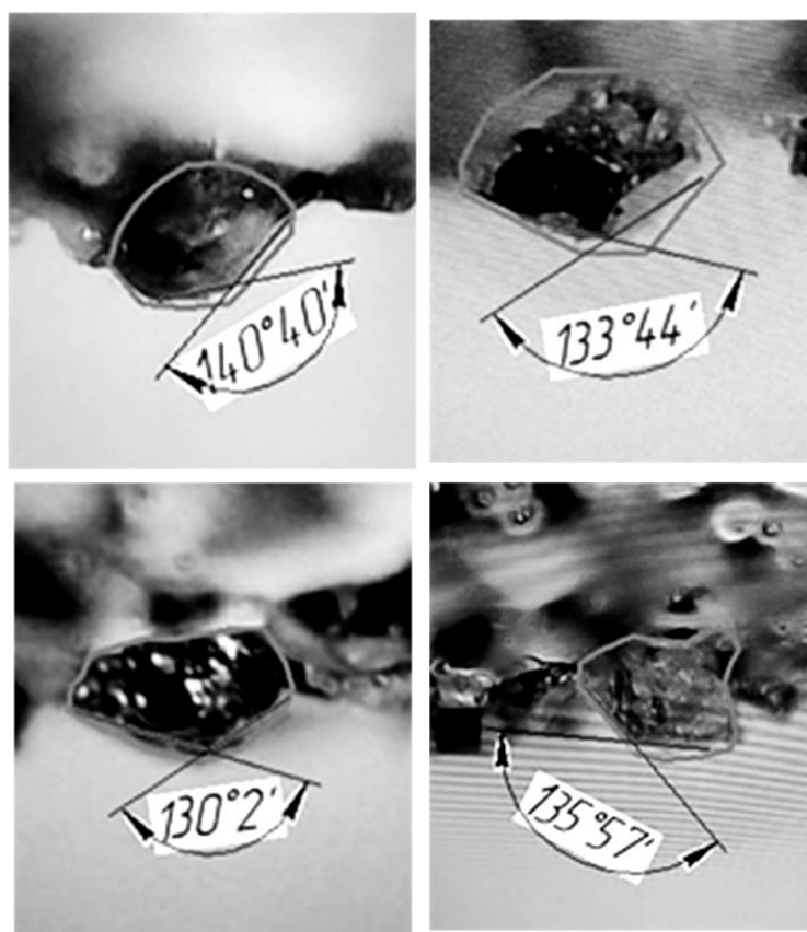
Рисунок 1 – Фрагмент поверхности круга с зернистостью алмазных зерен 125/100 (увеличение 100х)
