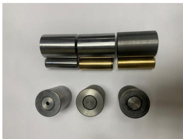
Рисунок 3 – Экспериментальные образцы: вал-втулка чугуна Сч20; сталь 40Х, бронза Бр. ОЦС 4-4-2,5
