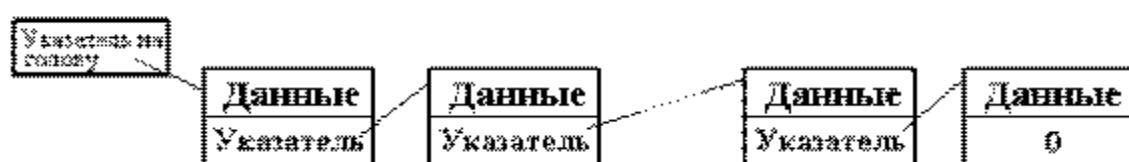
Рис. 2. Логическая структура односвязного списка
