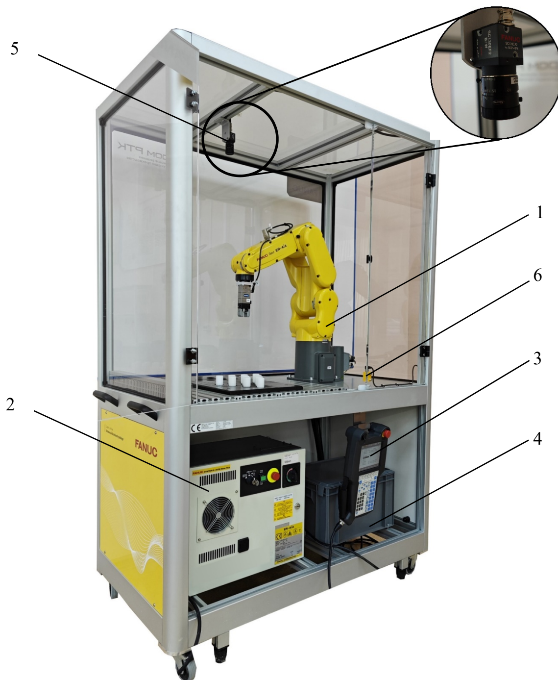
Рис. 2.1. Учебная роботизированная ячейка FANUC ER-4iA
