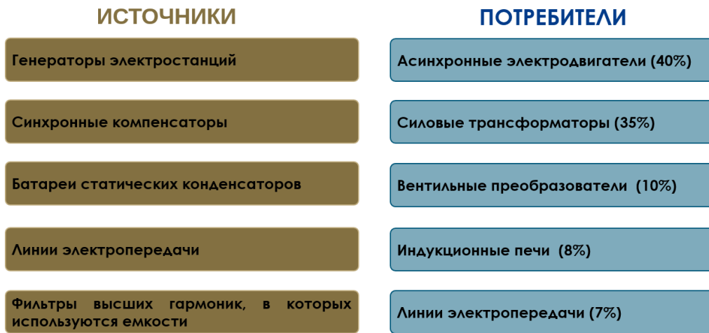
Рисунок 2 – Потребители и источники реактивной мощности
