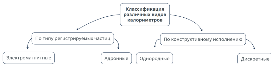
Рисунок 3 – Классификация различных видов калориметров
