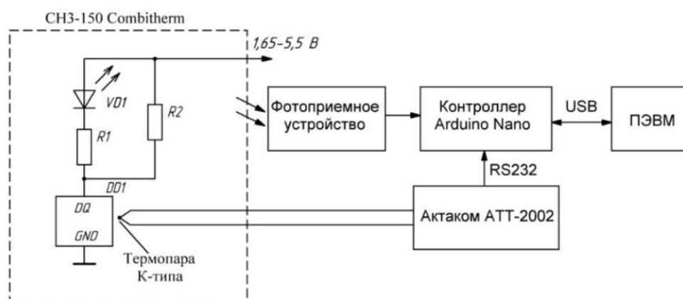
Рисунок 8 – Структурная схема установки для исследования датчика на основе микросхемы NST1001 с оптическим способом передачи информации
