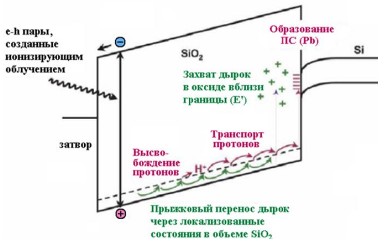
Рисунок 4. Зонная диаграмма МДП-структуры, иллюстрирующая основные зарядовые процессы, протекающие в ней при воздействии радиационного излучения при положительном потенциале на затворе [8]
