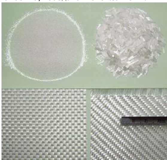
Рисунок 5 – Образцы стекловолокна и наполнители для композитных материалов
