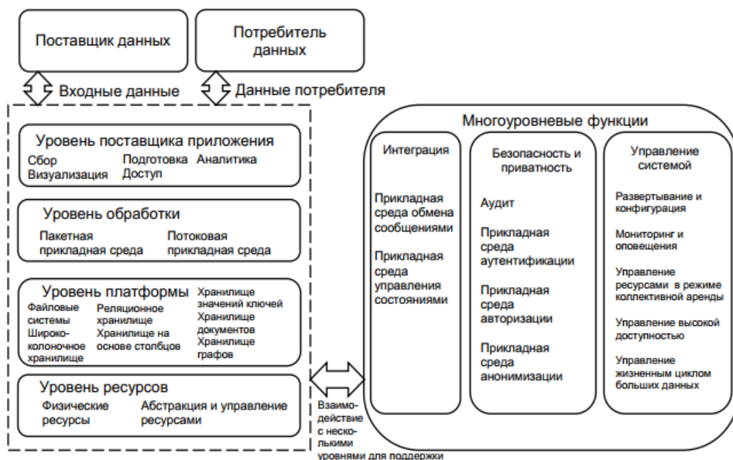
Рис. 5. Функциональные компоненты четырехуровневой архитектуры больших данных [19]
