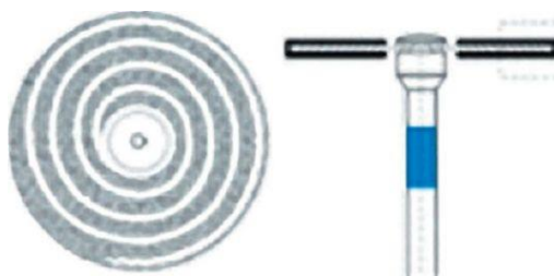
Рис. 79. Алмазный диск со спиралевидной насечкой
