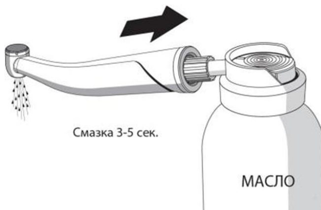
Рис. 72. Обработка наконечника под быстросъемное соединение
