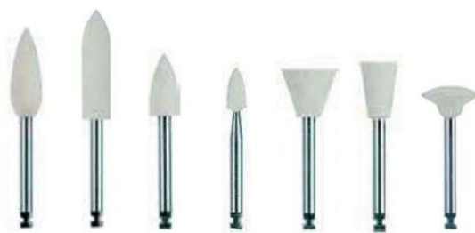
Рис. 89. Инструменты с насыпкой из карбида силикона
