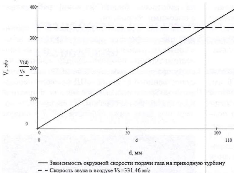
Рис. 3. График зависимости окружной скорости от диаметра крыльчатки
