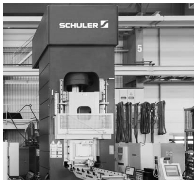
Рис. 7. Изотермический формовочный пресс фирмы Schuler GmbH
