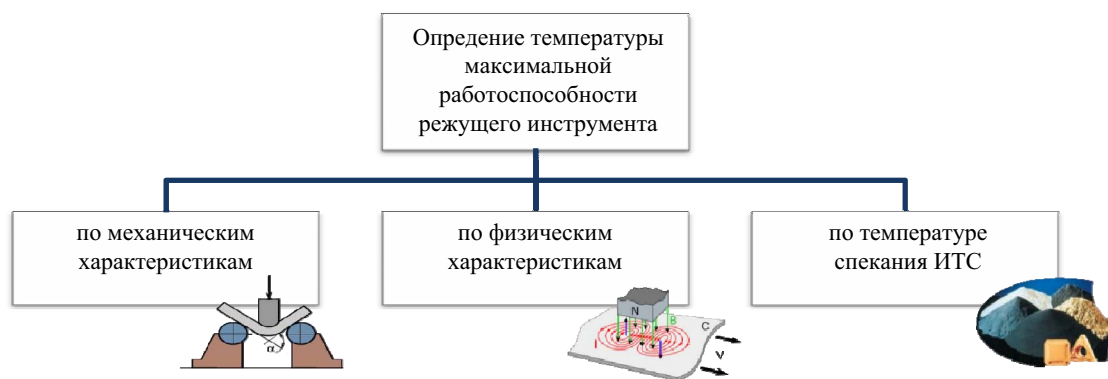
Рис. 1. Методы определения температуры максимальной работоспособности ИТС
