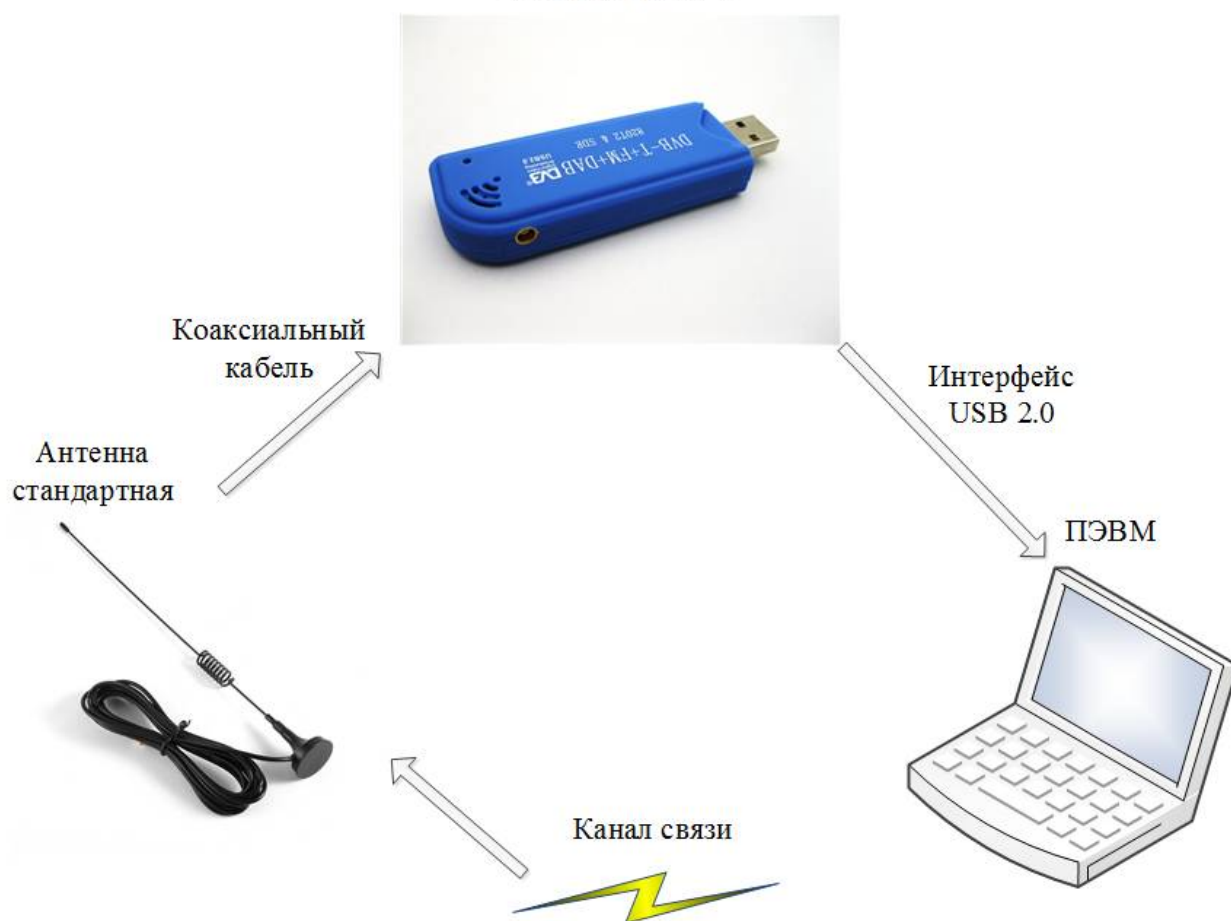
Рисунок 18 – Структура комплекса для выявления закладных устройств, работающих на частотах сотовой связи
