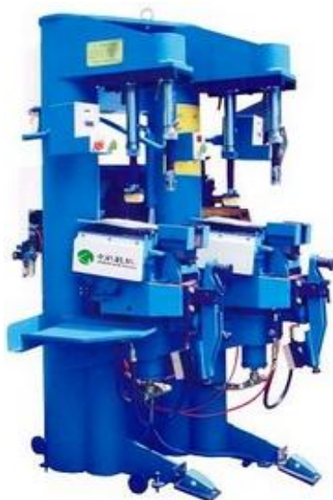
Рисунок 2.4 - Пресс для приклеивания подошв ZX-600
