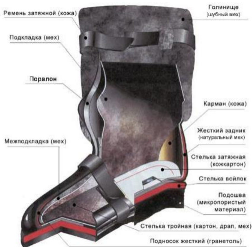
Рисунок 2.1 – Структурные элементы унтов
