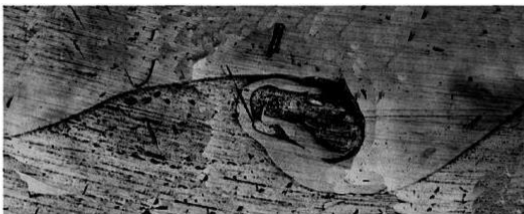
Рисунок 2.5 – Микроструктура соединения медно-алюминиевого композита в непосредственной близости от взрывателя
