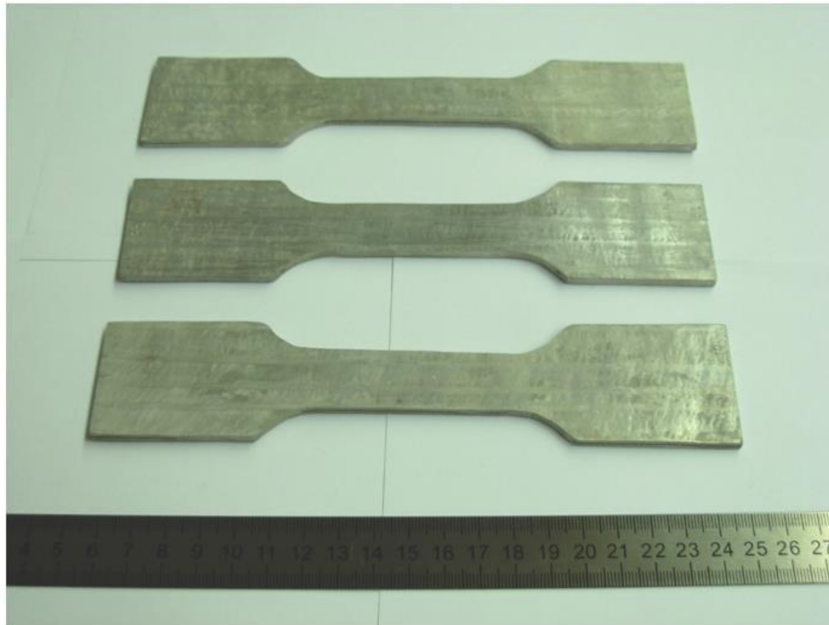
Рисунок 4 - Образцы для испытаний на разрывной машине по ГОСТ 1497–84.
