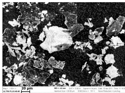
Рисунок 2.4 - Электронные фотографии порошка отходов кремнеграфитовых тиглей
