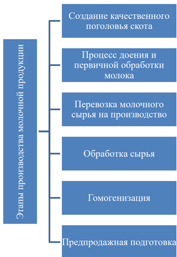
Рисунок – 5 Этапы производства молочной продукции
