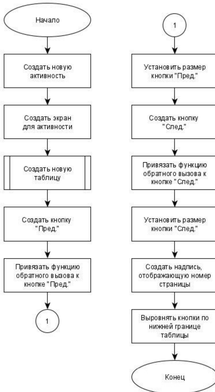
Рисунок К.1 – Графическое изображение алгоритма создания нового экрана для просмотра журналов
