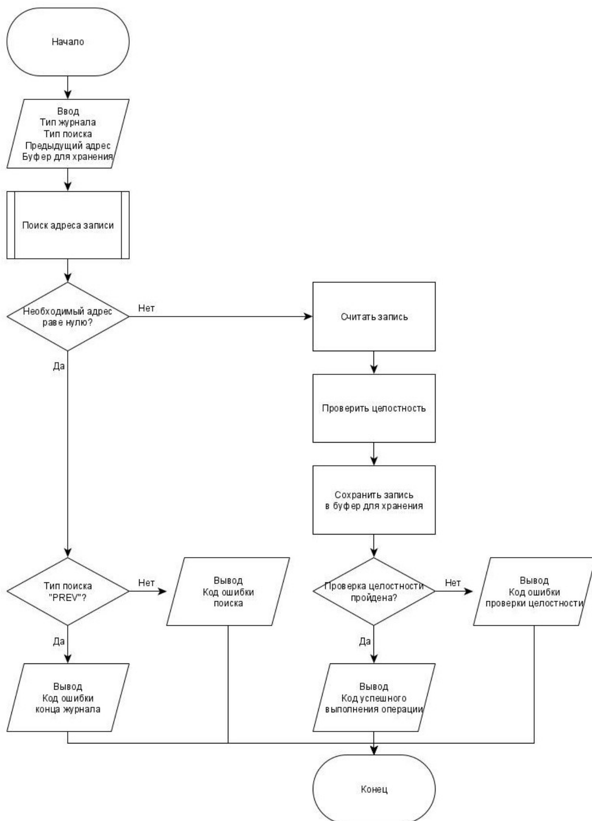
Рисунок Е.11 – Графическое изображение алгоритма получения необходимой записи в блоке
