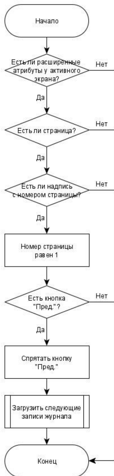
Рисунок К.3 – Графическое изображение алгоритма вывода на экран самых свежих записей
