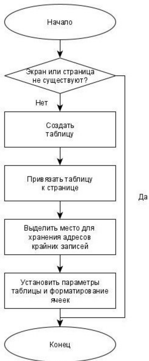
Рисунок К.2 – Графическое изображение алгоритма создания таблицы для просмотра журналов
