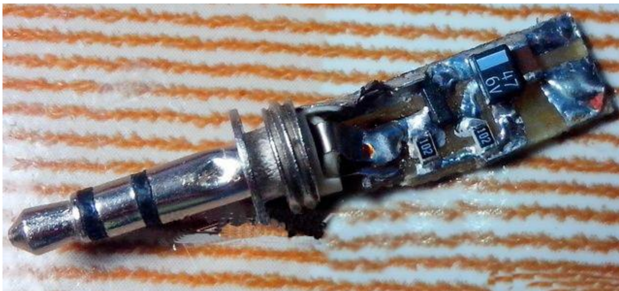
Рисунок 9 – Плата усилителя для электретного микрофона
