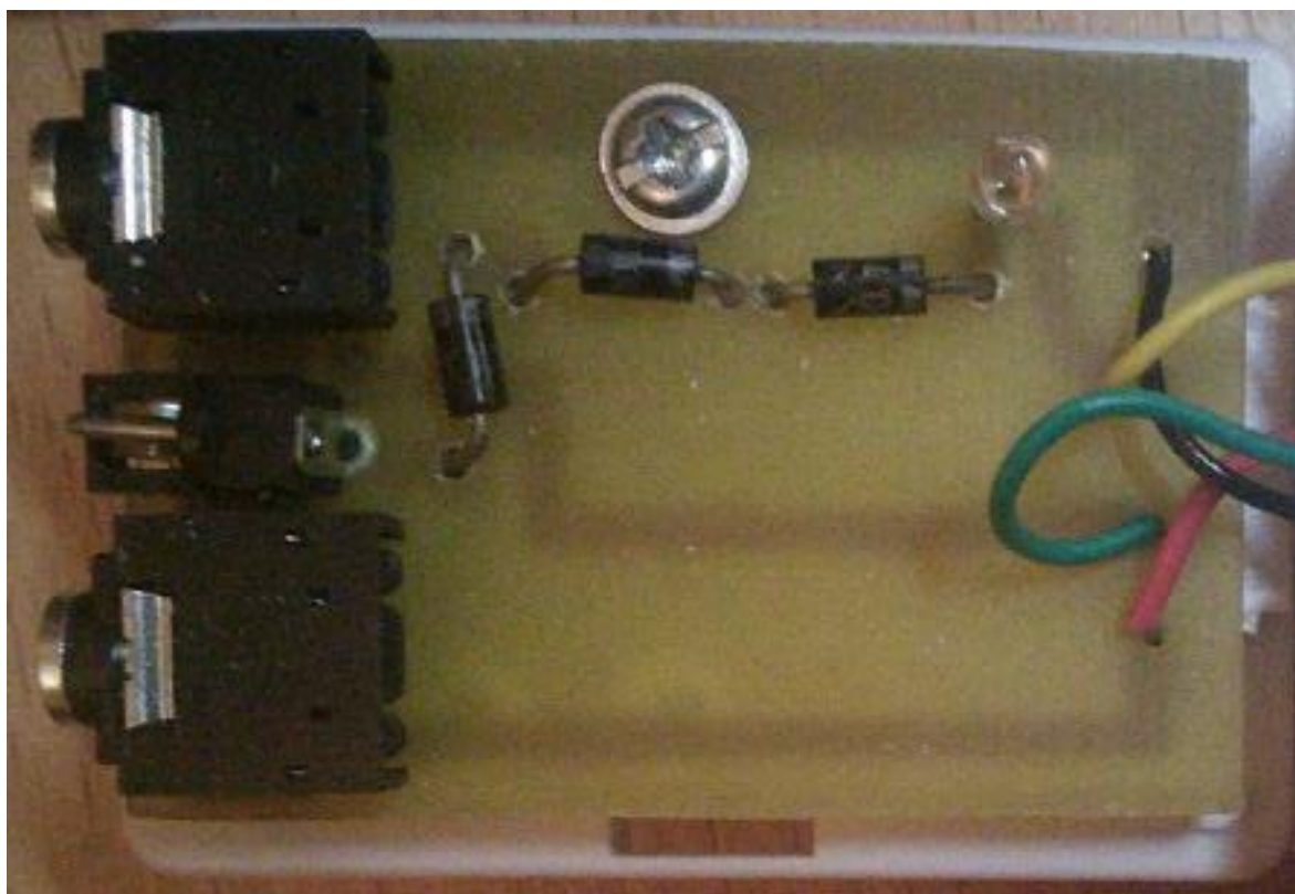
Рисунок 27 – Собранная схема блока питания
