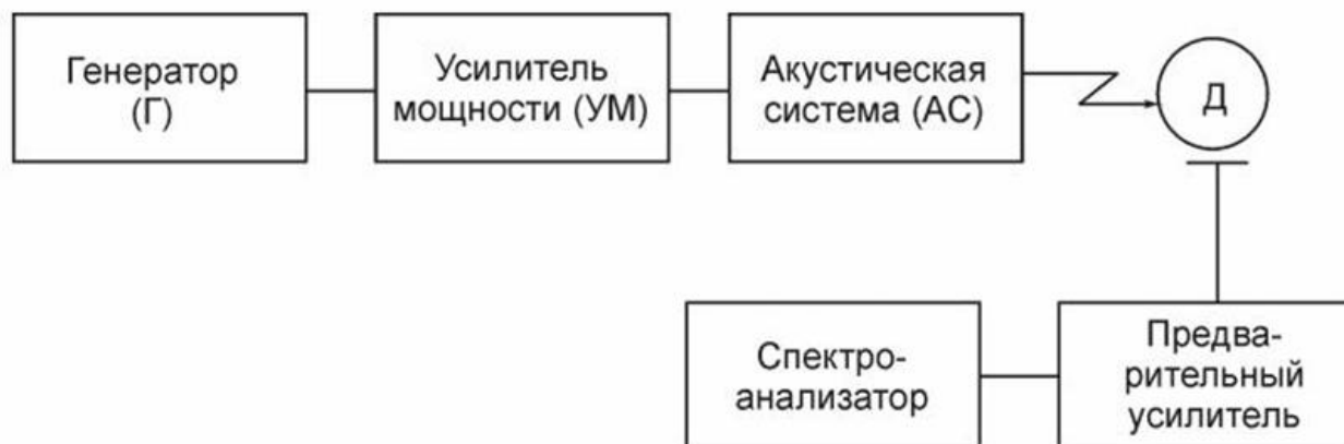
Рисунок 4 - Состав измерительной установки при контроле выполнения норм защищенности речевой информации с использованием спектроанализатора
