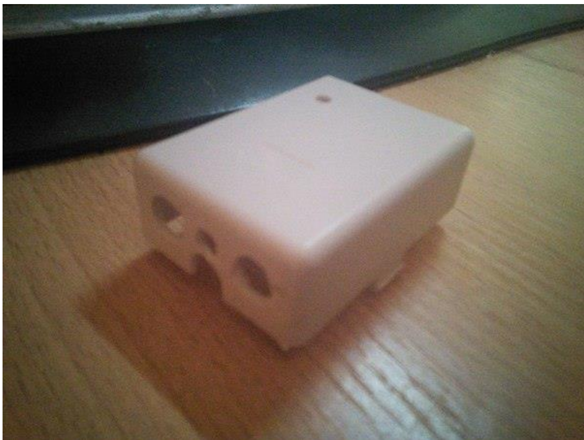
Рисунок 29 – Крышка корпуса блока питания
