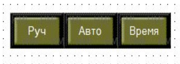
Рисунок 65 – Панель переключателей «Ручной», «Авто» и «По времени»
