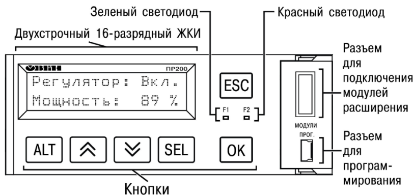
Рисунок 37 - Лицевая панель прибора
