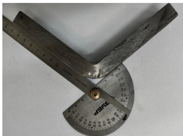
Рисунок 28 – образцов КСС из материалов с ВП: а) до проведения испытаний на статический изгиб; б) после проведения испытаний на статический изгиб
