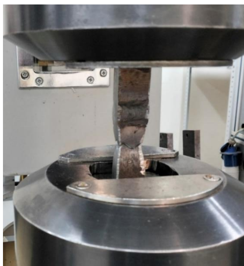
Рисунок 24 – Испытание на одноосное растяжение образца КСС из материала с ВП
