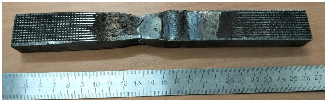
Рисунок 23 – Экспериментальный образец сваренного материала с ВП: а) до проведения испытаний на одноосное растяжение; б) и в) после проведения испытаний на одноосное растяжение.
