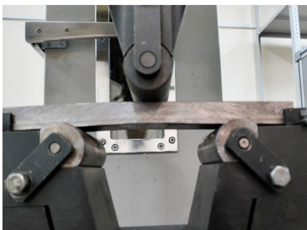
Рисунок 28 – образцов КСС из материалов с ВП: а) до проведения испытаний на статический изгиб; б) после проведения испытаний на статический изгиб
