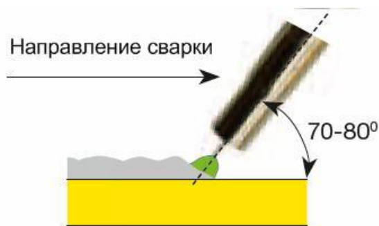
Рисунок 19 – направление сварки углом назад
