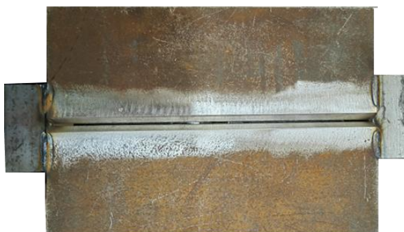
Рисунок 10 – Сборка под сварку 4-х слойного материалов с ВП с выставленным зазором с применение выходных торцевых планок
