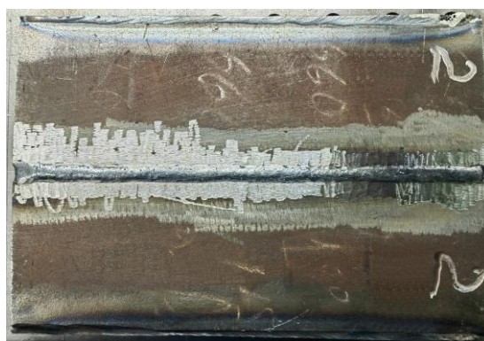
Рисунок 21 – Схема сварки и сваренный образец способом FCAW : а) схема сварки материала с ВП со стороны основного слоя: 1- корневой проход; 2- заполняющий проход; 3- облицовочный шов; сварка плакирующего слоя материала с ВП : 4 - заполняющий проход; 5 - облицовочный шов.; б) сваренный образец способом сварки FCAW
