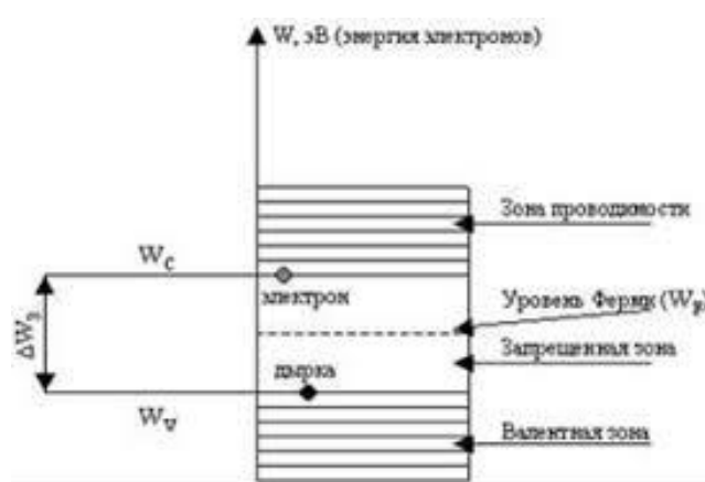
Рисунок 1.1 — Энергетическая диаграмма собственного полупроводника
