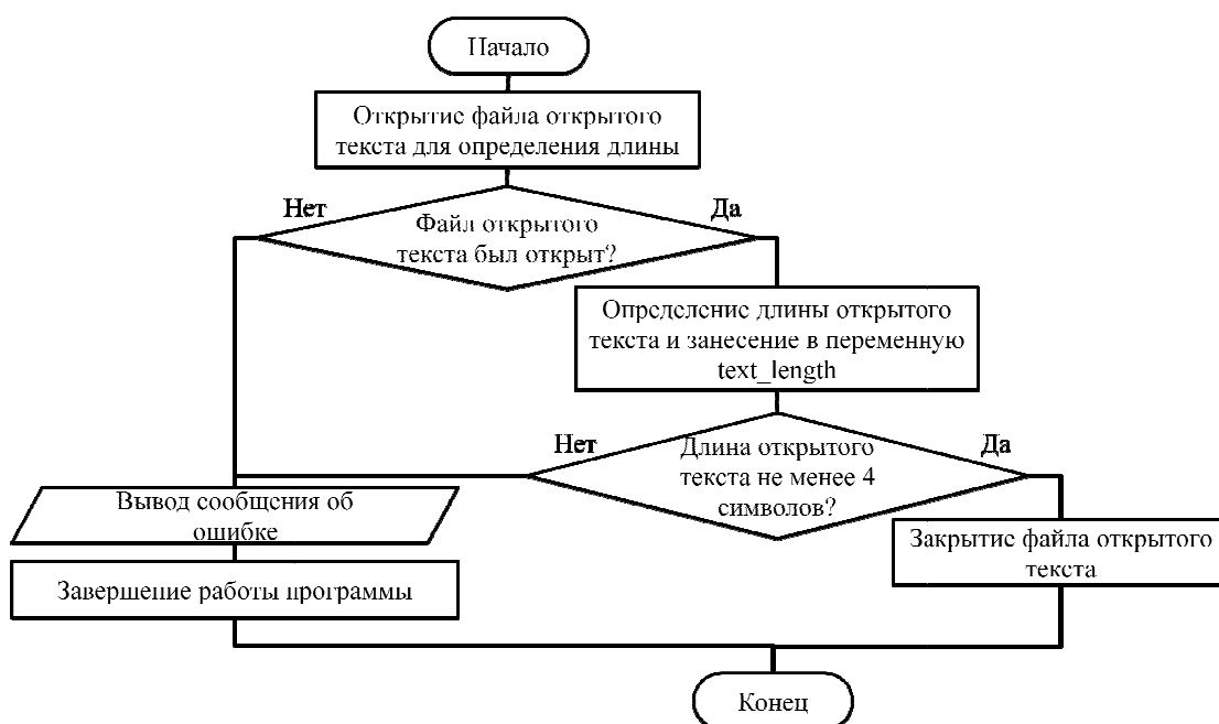
Рисунок 9 – Алгоритм функции открытия файла открытого текста
