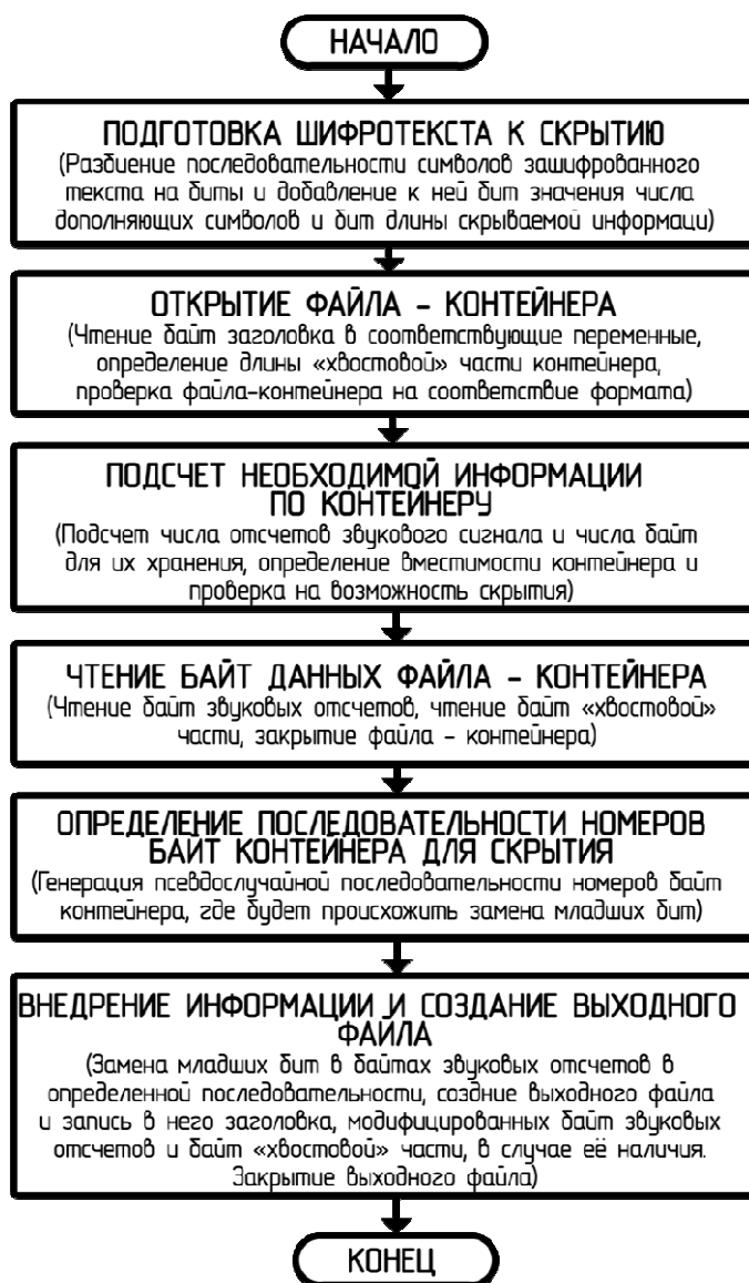
Рисунок 13 – Алгоритм стеганографического скрытия информации
