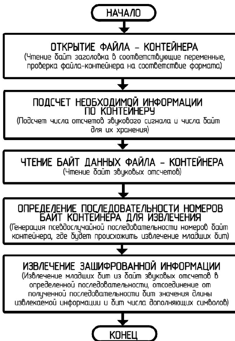
Рисунок 25 – Алгоритм стеганографического извлечения информации
