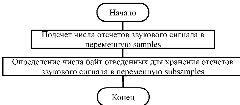
Рисунок 27 – Алгоритм функции подсчета необходимой информации по стеганографическому контейнеру
