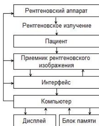
Рисунок 2.4 — Основные элементы системы для проведения цифровой рентгенографии
