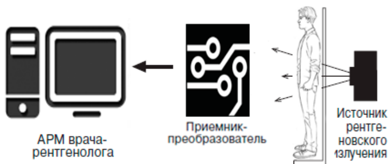
Рисунок 2.3 — Схема непосредственного формирования цифрового рентгеновского изображения
