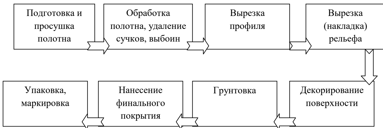
Рисунок 2.4 – Операционная технология изготовления деревянного багета в ООО «ЭкоБагет»
