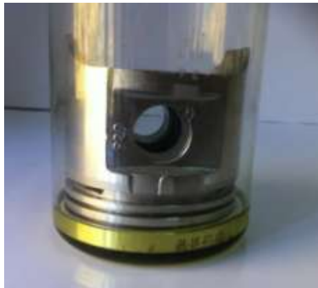
Рисунок 5.5 – Обработка оксидированного поршня раствором
