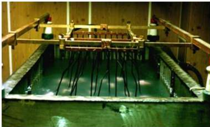
Рисунок 5.1 – Установка для микродугового оксидирования
