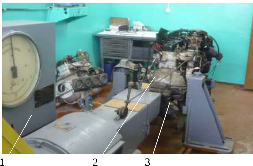
Рисунок 5.6 – Экспериментальный стенд: 1 – тормозной стенд КИ-5543; 2 – двигатель бензиновый УМЗ-417; 3 – система удаления отработавших газов
