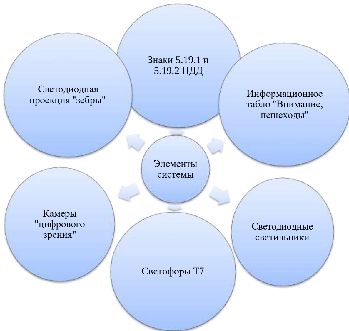
Рисунок 2.2 – Состав аппаратно-программного комплекса «Умный пешеходный переход»
