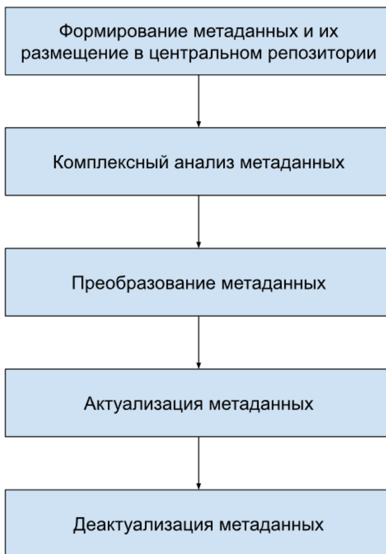
Рисунок 4 – Жизненный цикл метаданных сервиса обработки событий
