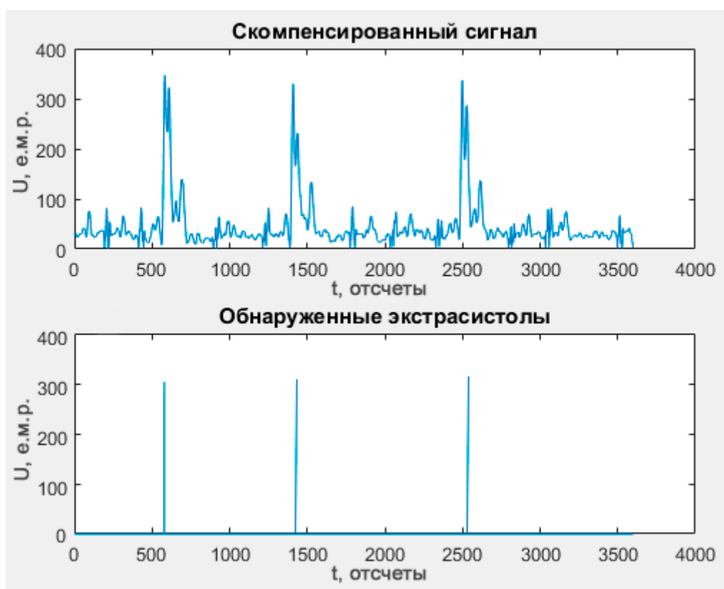
Рисунок 4.23 – Результат работы алгоритма MSMI на примере участка сигнала № 221
