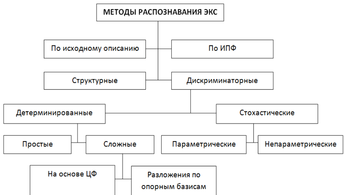
Рисунок 2.1 – Схема систематизации методов распознавания ЭКС
