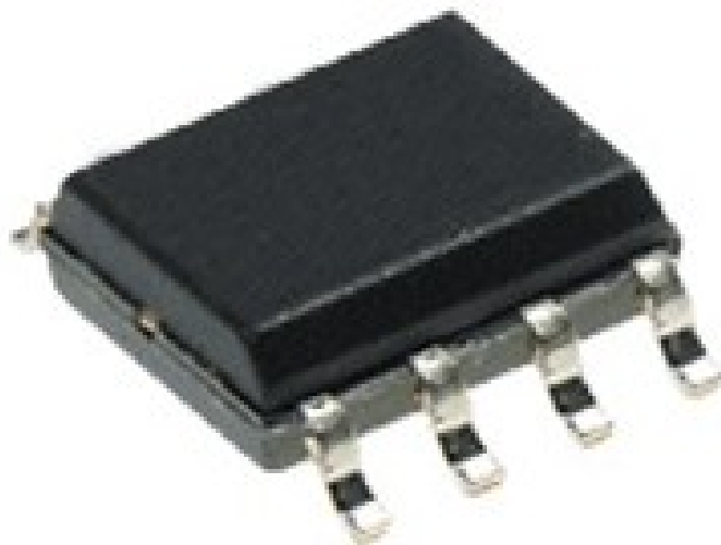
Рисунок 1.2 –Операционный усилитель NE532D
