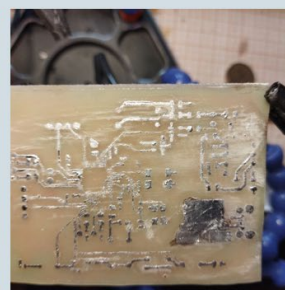
Изготовление отверстий и населения припоя на сигнальных линиях
