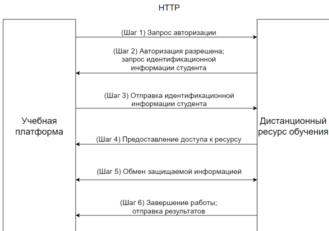
Рисунок 2 — Схема установления соединения и обмена данными в стандарте SCORM
