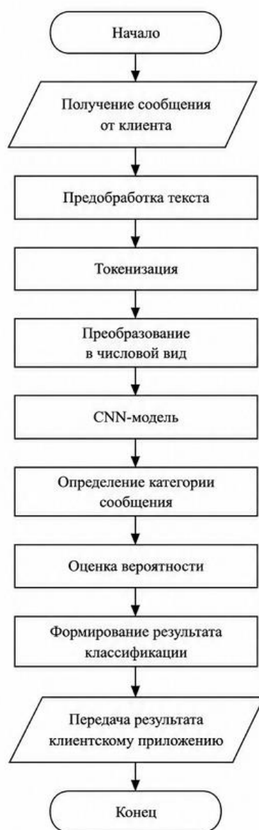
Рисунок 5 – Алгоритм классификации текстового сообщения
