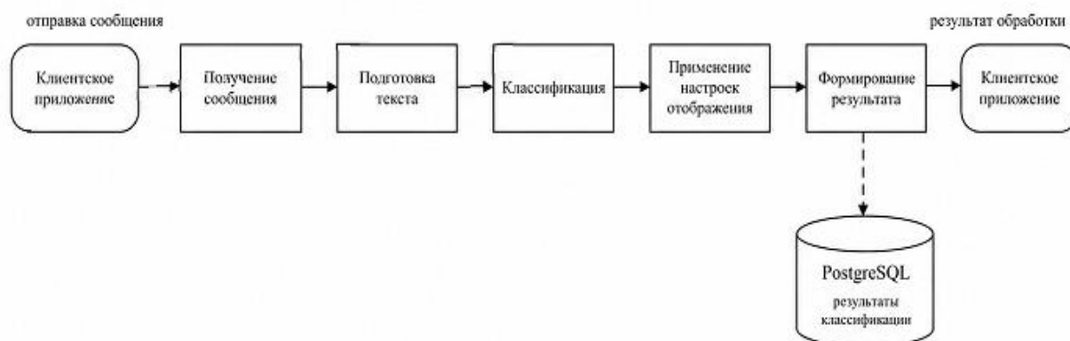
Рисунок 3 – Укрупнённая схема выполнения алгоритма классификации и фильтрации сообщений
