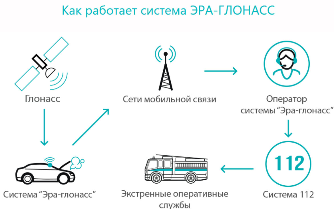
Рисунок 5 – Схема работы ЭРА-ГЛОНАСС
