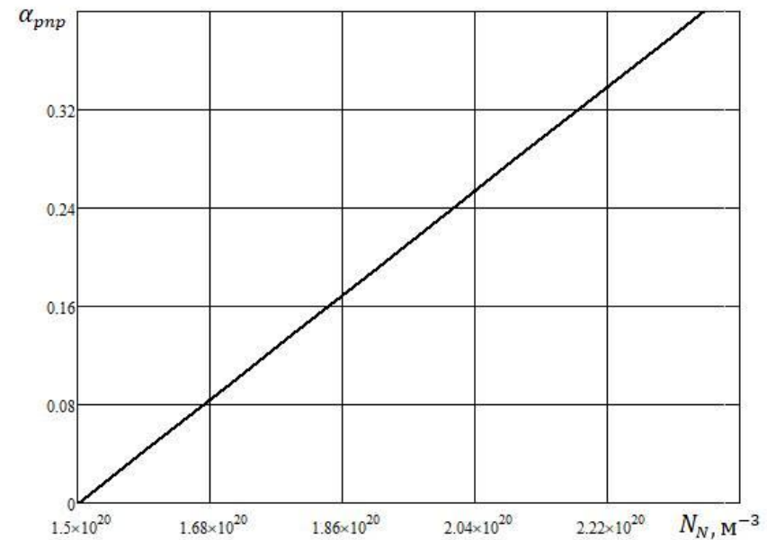
Рисунок 7 – Зависимость коэффициента передачи от концентрации примеси в базе n -типа
