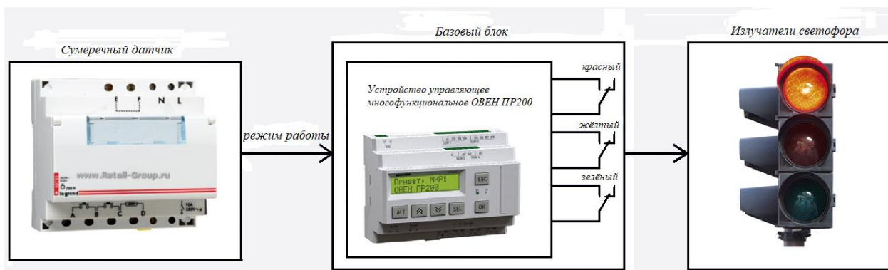
Рисунок 56 – Структурная схема программы
