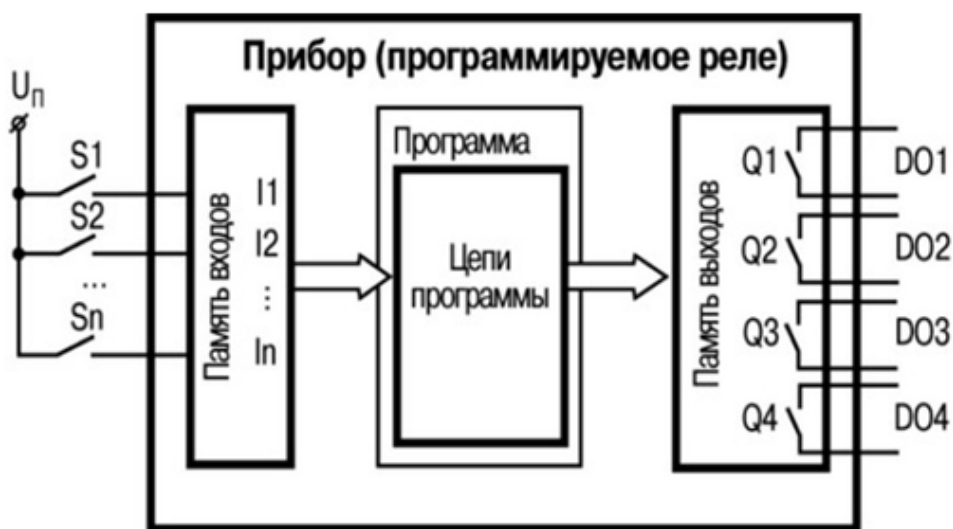
Рисунок 2 – Функциональная схема выполнения программы ПЛК
