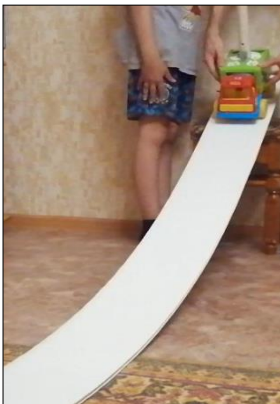
Рис. 16. Опыт, демонстрирующий изменение веса тела при движении по вогнутой траектории
