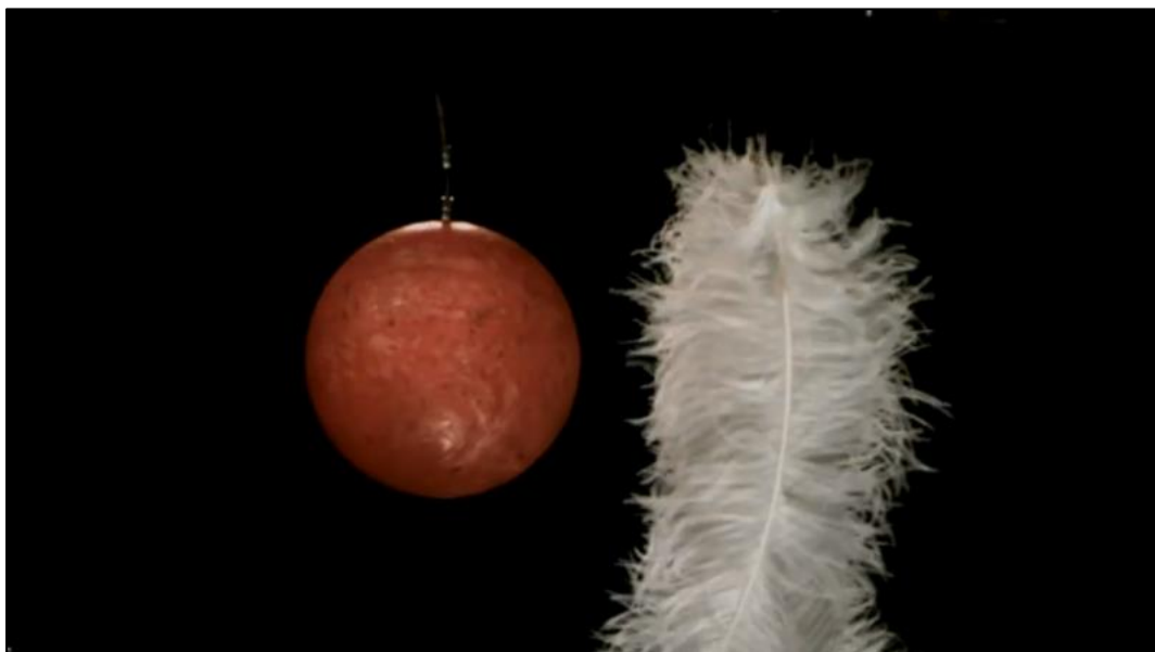
Рис. 2. Опыт, демонстрирующий свободное падение тел разной массы в сосуде с вакуумом
