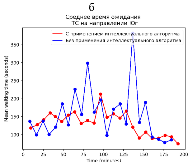
Рисунок 10 – Графики среднего времени ожидания машин по направлениям после обучения нейронной сети (а – направление север, б – направление юг, в – направление восток, г – направление запад)
