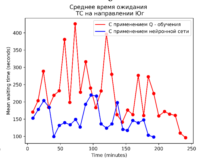
Рисунок 13 (а, б, в, г) – Сравнительные графики среднего времени ожидания для каждого направления (а – направление север, б – направление юг, в – направление восток, г – направление запад)
