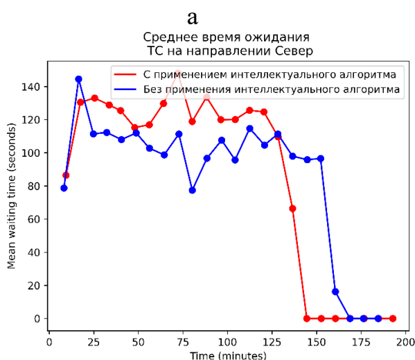
Рисунок 10 – Графики среднего времени ожидания машин по направлениям после обучения нейронной сети (а – направление север, б – направление юг, в – направление восток, г – направление запад)
