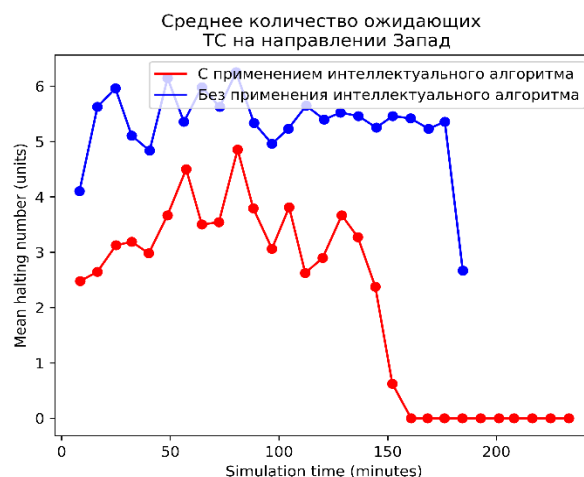
Рисунок 6 – Графики средней длины очереди по направлениям после обучения Q – модели (а – направление север, б – направление юг, в – направление восток, г – направление запад)
