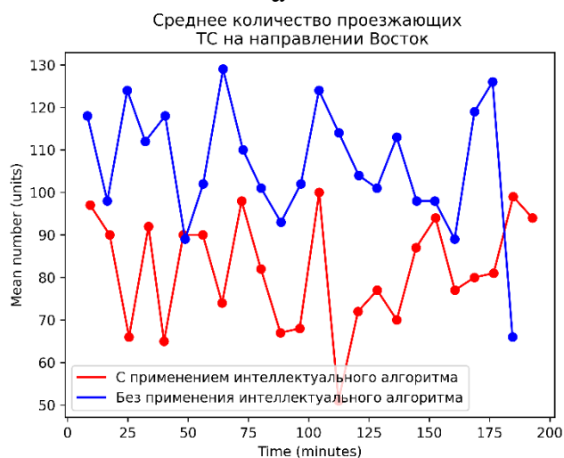
Рисунок 12 – Графики среднего количества машин по направлениям после обучения нейронной сети (а – направление север, б – направление юг, в – направление восток, г – направление запад)
