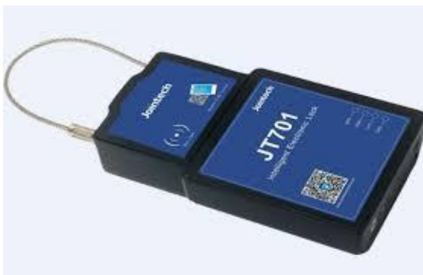
Рисунок 7 – Электронная навигационная пломба [16, с. 145]
