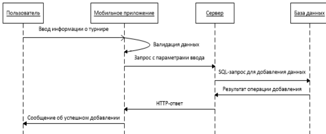
Рисунок 16 – Диаграмма последовательности для варианта использования «Добавить турнир»
